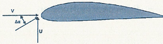
Abbildung 2: Änderung des Anstellwinkels durch senkrecht einströmende Böe, Bild aus [6].
